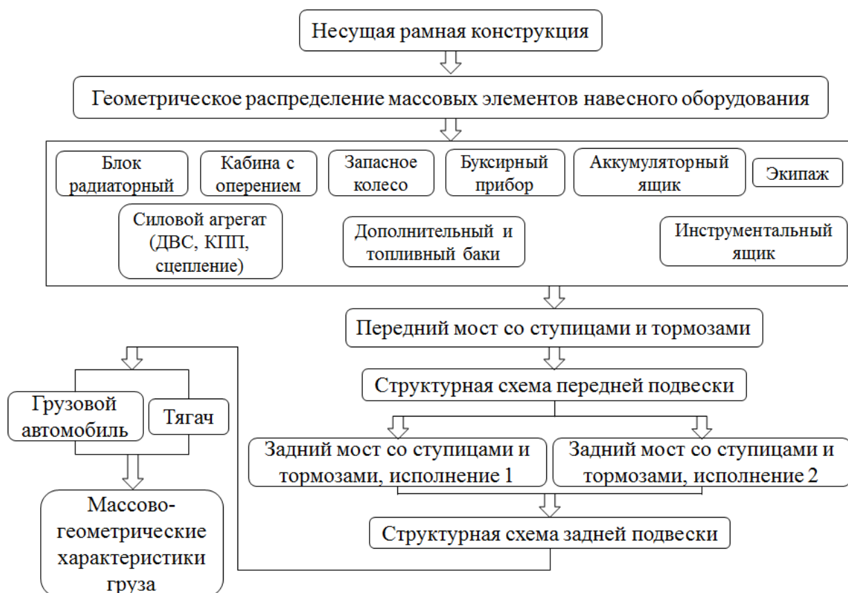
Рисунок 3.4. Схема формирования различных вариантов исполнения грузового автомобиля
