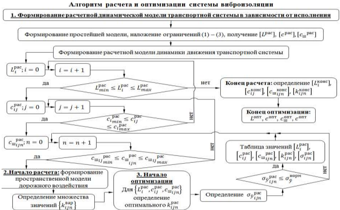
Рисунок 3.2. Алгоритм методики оптимизации и расчета параметров системы виброизоляции с точки зрения минимума вибрационных нагрузок
