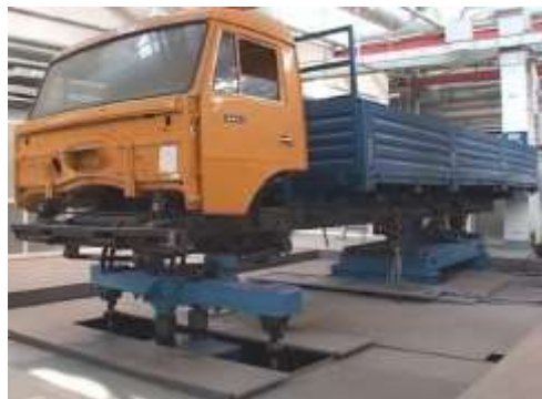
Рисунок 4.1. Испытательный стенд для исследования динамики конструкции транспортной системы
