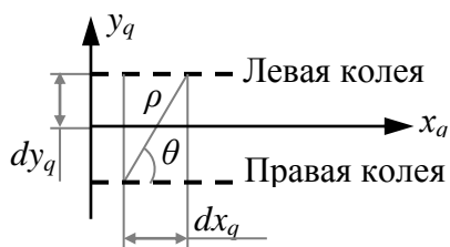
Рисунок 2.2. Схема профиля дороги с учетом правой и левой колеи
