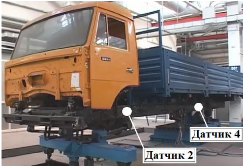
Рисунок 17. Испытательный стенд для исследования динамики конструкции транспортной системы
