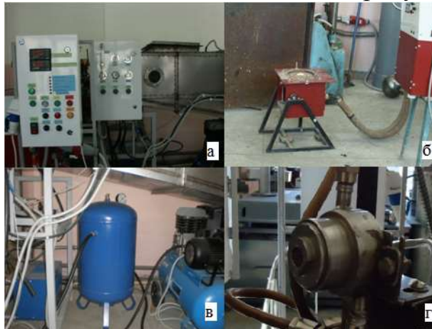
Рисунок 9. Основные технологические узлы установки УРМ-001: а – блок управления, б – плавильная печь, в – компрессор, г – распылительная форсунка
