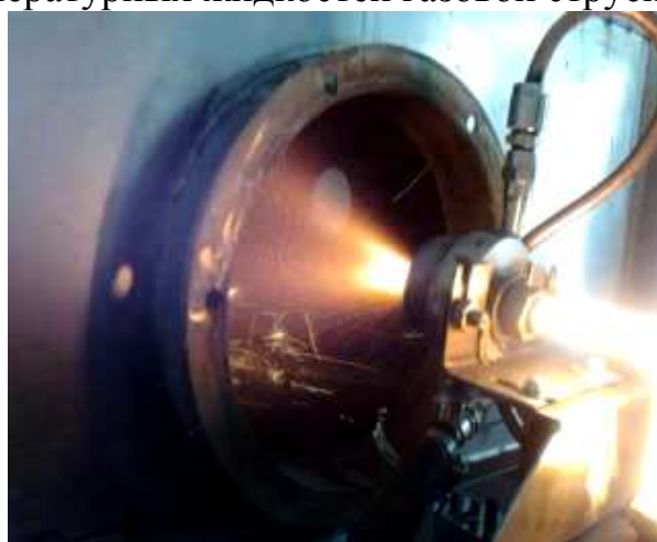
Рисунок 11. Процесс распыления жидкого металла в УРМ-001
