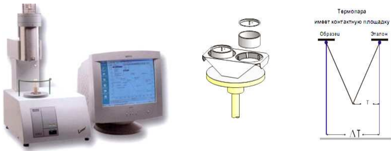
Рис. 1. Установка дифференциальной сканирующей калориметрии
